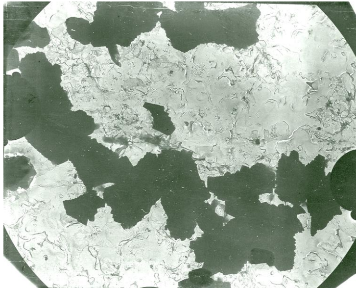
Рисунок 3 - Отдельности угля из пласта h_7 , марка Ж, глубина 1200 м, шахта им. А.А. Скочинского, Донецко-Макеевский район, ув. 2000 крат; электронный микроскоп
