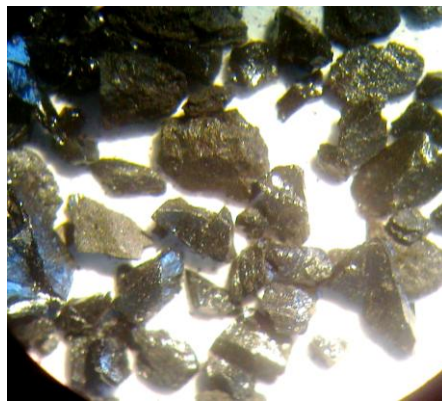
Рисунок 4 - Штыб угля пласта m_3 после гидродинамического воздействия; размер изометрических частиц от 100 до 500 микрон; фотоснимок
