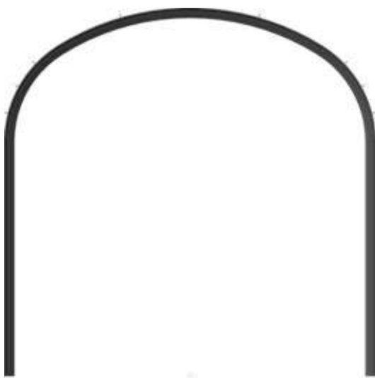
Рисунок 1 - Просторова модель рами аркового металевого кріплення з профілю СВІІ-22
