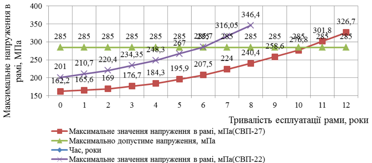
Рисунок 3 - Графік залежності росту напружень в рамі відносно ступеня корозії
