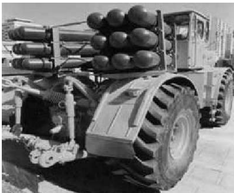
Рисунок 1 - Зовнішній вигляд трактора К-701 з газобалонною установкою
