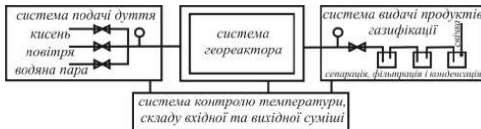
Рисунок 1 - Технологічна схема стендової установки підземної газифікації вугілля
